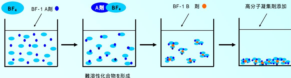
BF-1 A剤とホウフッ化物が直接反応して難溶性の化合物を生成し、難溶性化合物にBF-1B 剤と高分子凝集剤を添加することで排水中からホウフッ化物を除去できる。
